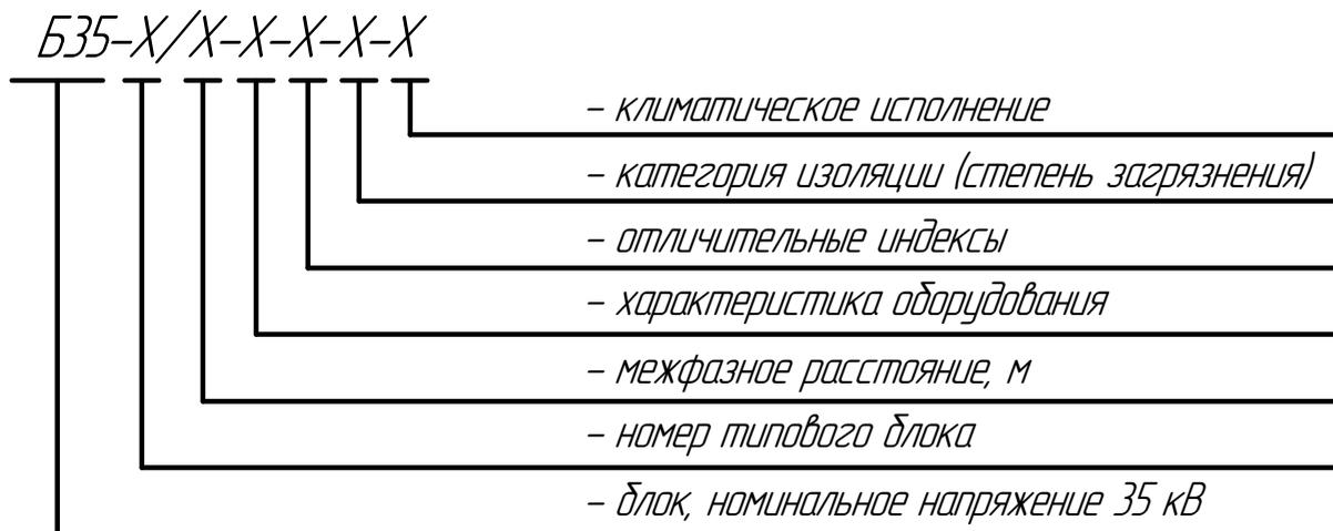
**Блок** – опорная металлоконструкция на которую устанавливается до шести трёхфазных высоковольтных аппаратов
